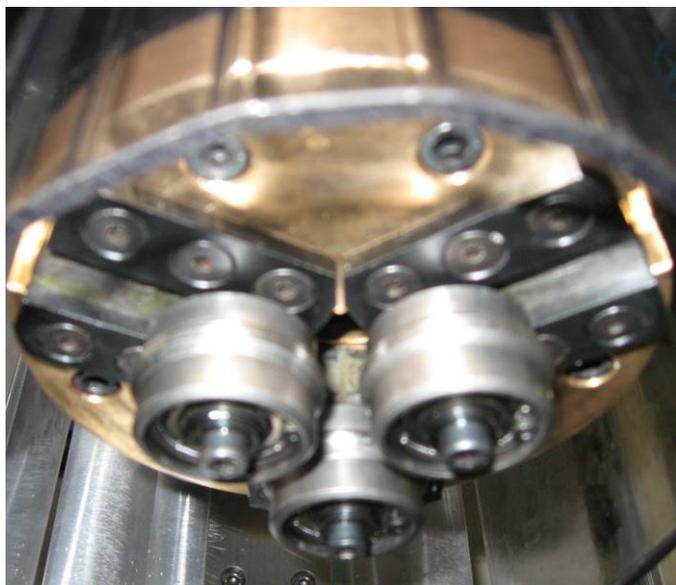
Testa di rullatura autocentrante con sensore di misura centrale.
