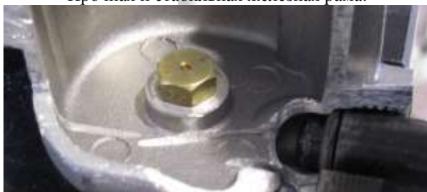
Утечка из конического седла или из резьбы.
